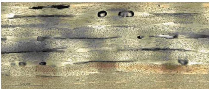
Рис. 11. Макрошлиф дефектного участка конструкции из стеклопластика
