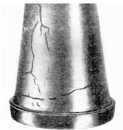
Рис. 22. Вид поверхности детали с трещиной
