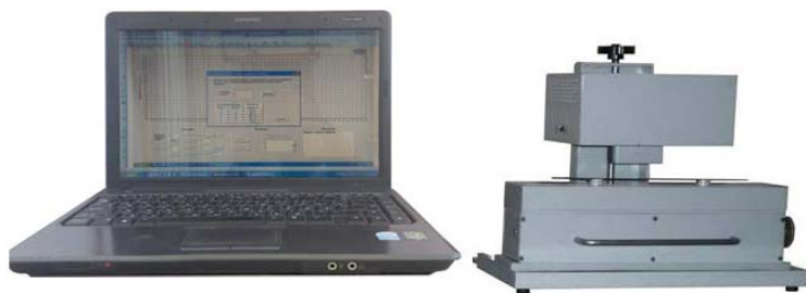
Рис. 18. Установка для измерения динамического модуля упругости и логарифмического декремента затухания
