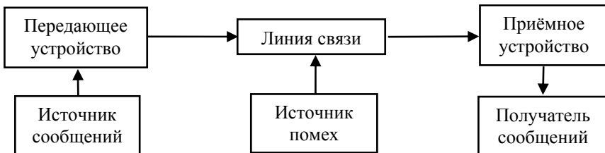
Рис. 1. Обобщённая структурная схема системы передачи информации
