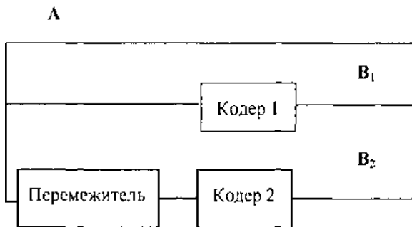
Рис. 10. Структурная схема турбо-кодера
