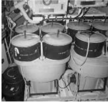
Рис. 47. Система очистки от CO 2 (США) с натронной известью
