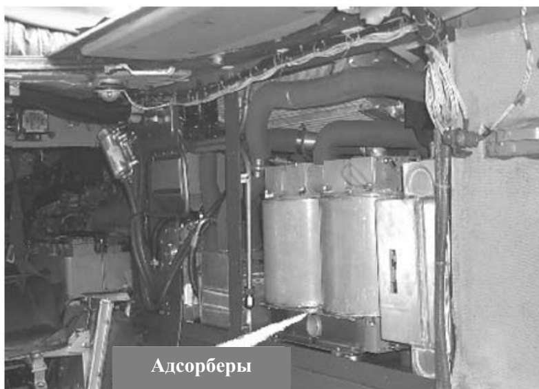
Рис. 87. Размещение установки КСЗ в корпусе военной инженерной машины «Terrier»
