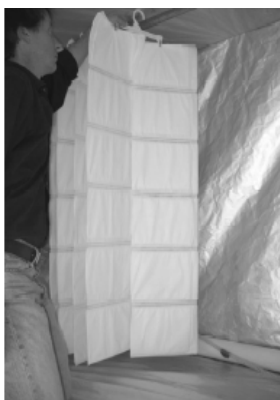
Рис. 55. Поглотитель CO 2 ExtendAir на основе LiOH фирмы Micropore Inc.:
