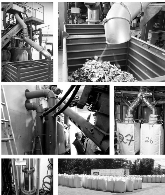
Рис. 3.26. Процесс измельчения корпуса холодильника
