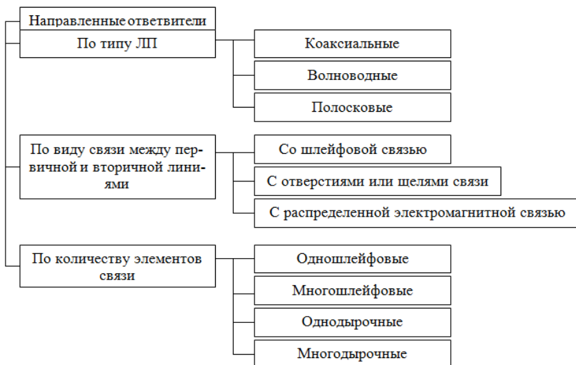
Рис. 2.33. Классификация направленных ответвителей
