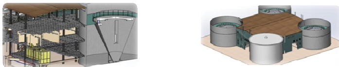
Рис. 1. 3D-модель станции полной биологической очистки сточных вод БР-12000
