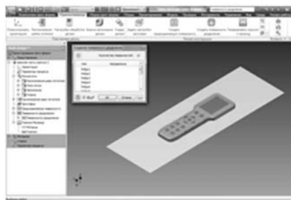
Рис. 7. Создание поверхности разделения матрицы и пуансона
