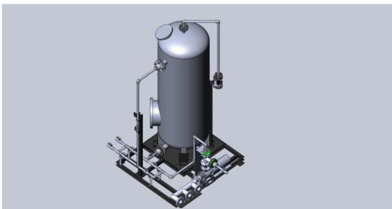
Рис. 2. 3D-вид модели установки фильтра для сорбционной очистки стоков
