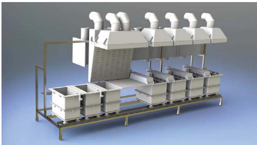
Рис. 3. 3D-вид модели комплекта ванн ручного обслуживания гальванической линии для цинкования стальных деталей
