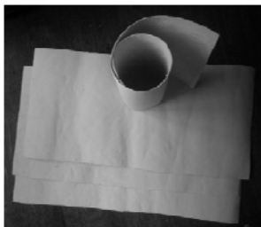
Рис. 77. Внешний вид листового хемосорбента с полимерным связующим
