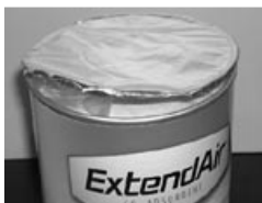
Рис. 36. Упаковка с картриджем ExtendAir (а) и дефект при вскрытии упаковки (б)
