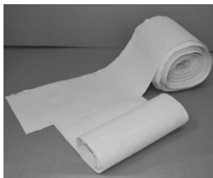
Рис. 77. Внешний вид листового хемосорбента с полимерным связующим
