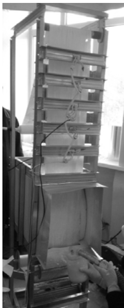
Рис. 75. Внешний вид (а) и схема (б) установки формирования методом напыления и сушки листового хемосорбента со связующим ПВС:
