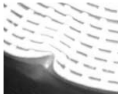
Рис. 36. Упаковка с картриджем ExtendAir (а) и дефект при вскрытии упаковки (б)
