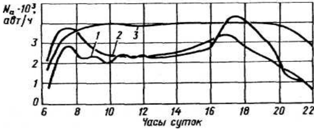
Рис. 10.3. Изменение интенсивности в течение суток на городской магистрали радиального направления: 1 – движение из центра; 2 – движение к центру; 3 – движение в условиях перенасыщения транспортным потоком
