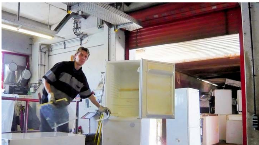
Рис. 3.23. Извлечение внутренних съёмных частей холодильника
