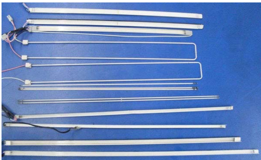
Рис. 3.15. Внешний вид люминесцентных ламп с холодным катодом для ЖК-дисплеев
