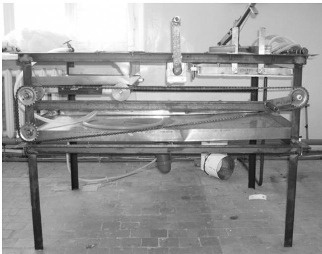
**Рис. 21. Внешний вид пилотной установки пропитки пористой матрицы щелочным раствором пероксида водорода**
