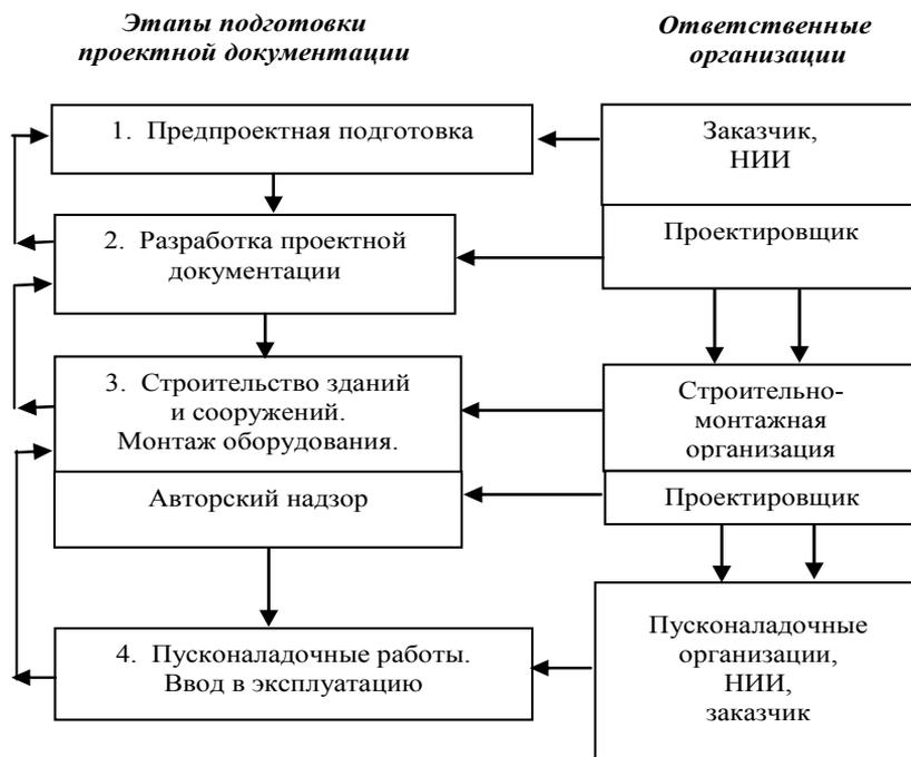
Рис. 1.2. Блок-схема принятия решений в процессе проектирования и создания промышленного объекта
