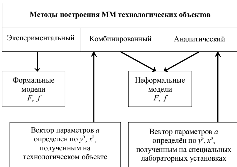
Рис. 5. Схема классификации методов построения ММ
