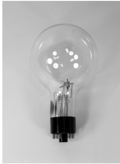
Рис. 2. Электронная лампа с пушкой
