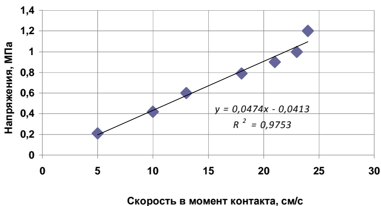
Рис. 4.18. Зависимость контактных напряжений от скорости плиты в момент контакта с поверхностью уплотняемого материала
