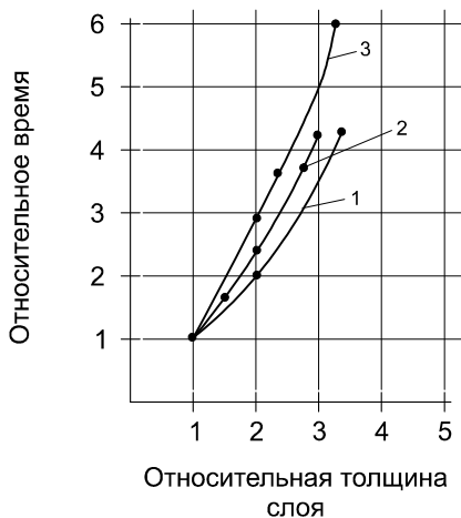
Рис. 3.20. Влияние относительной толщины уплотняемого слоя на продолжительность работ по устройству покрытия из горячей смеси:
