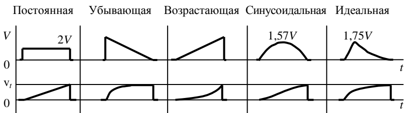
Рис. 4. Формы скорости вдувания для одинаковых v_t и T_I
