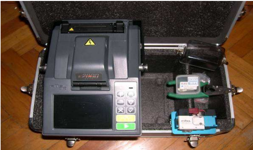
Рис. 1.23. Сварочный аппарат для монтажа волоконно-оптического кабеля
