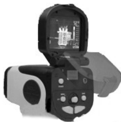
Рис. 1.34. Внешний вид современного тепловизора
