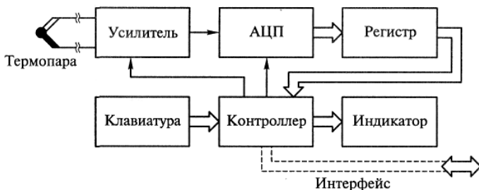
Рис. 1.27. Структурная схема цифрового термометра
