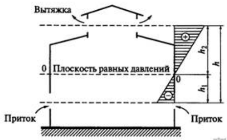
Рис. 2.4.3. Схема распределения давления воздуха при естественной вентиляции в здании
