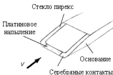
Рис. 1.1.9. Поверхностный чувствительный элемент термоанемометра
