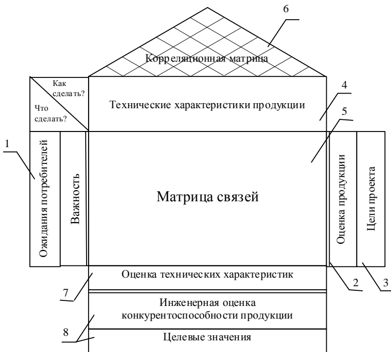
Рис. 3.9. Базовая структура QFD-диаграммы («Дома качества») [1, 8, 14, 23, 24, 63]
