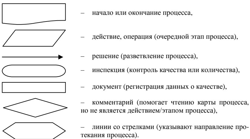
Рис. 2.10. Символы, применяемые на поточных диаграммах процессов
