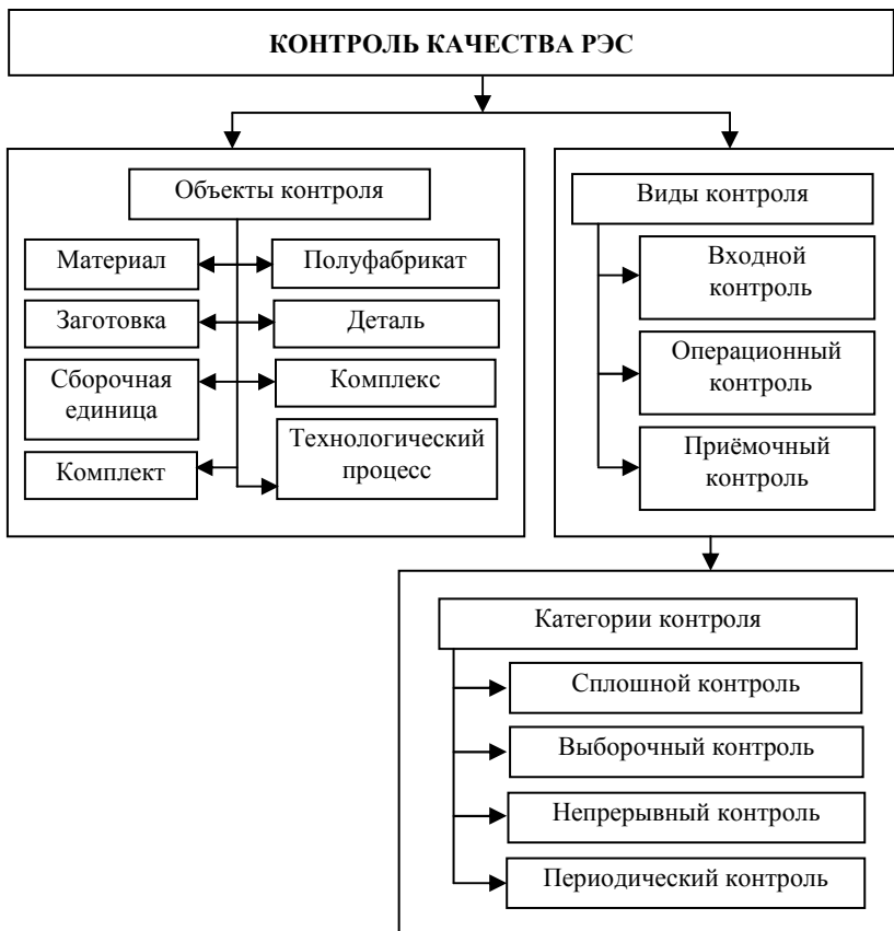
Рис. 5.1. Контроль качества РЭС
