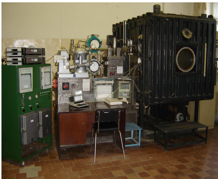
Рис. 30. Стенд-имитатор внешнего дыхания человека «Искусственные легкие» с термокамерой:
