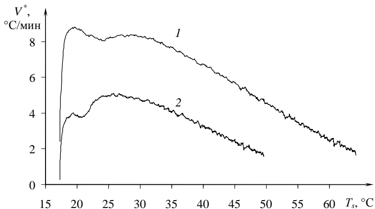
Рис. 7.64. Значения скоростей нагрева в точках контроля: r = 7 мм (1), r = 9 мм (2).
