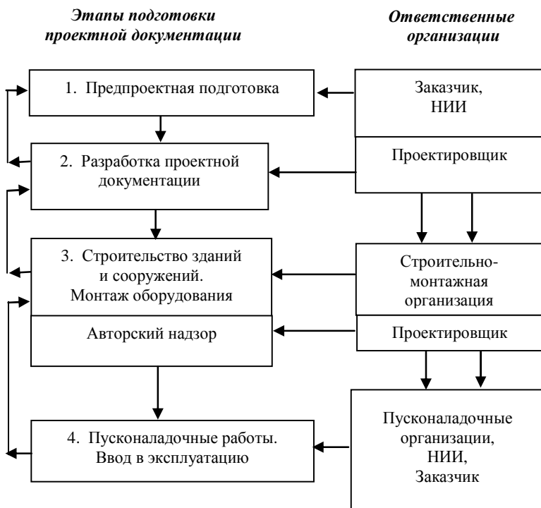
Рис. 1.7. Блок-схема принятия решений в процессе проектирования и создания промышленного объекта
