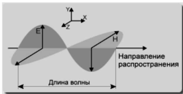
Рис. 9.1. Электрическое и магнитное поля электромагнитных волн
