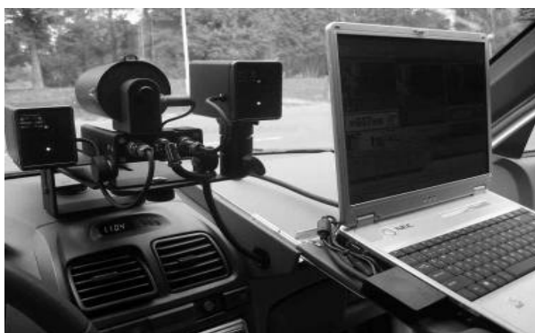
Рис. 3.8. Аппаратно-программный комплекс идентификации транспортных средств по государственному регистрационному знаку «Поток-Д»
