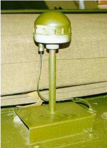
Рис. 2.47. Блок антенный
