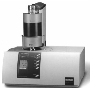
Рис. 1.19. Общий вид дифференциально-сканирующего калориметра DSC-404 F3 Pegasus фирмы Netzch
