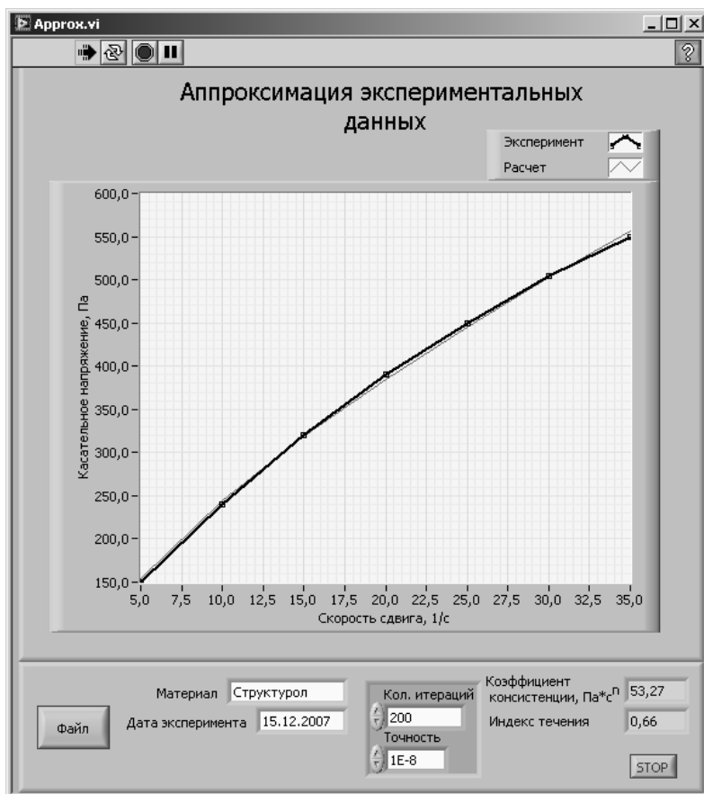
Рис. 3.14. Лицевая панель виртуального прибора, реализующего обработку экспериментальных данных на стадии определения реологических характеристик неньютоновских жидкостей при сдвиговом течении
