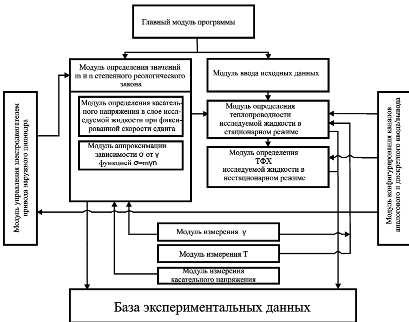
Рис. 3.10. Структура программного обеспечения автоматизированной экспериментальной установки
