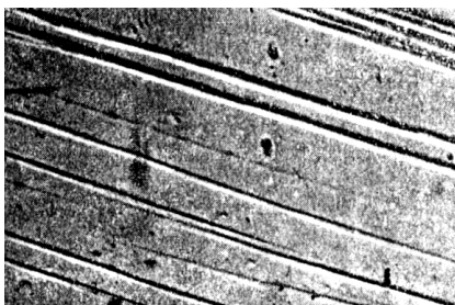
Рис. 2. Линии скольжения на поверхности полированного железа (увеличение 100\times )
