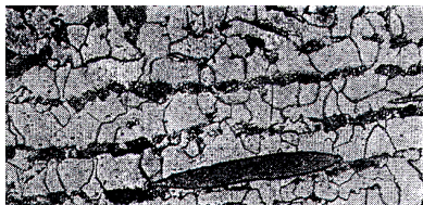
Рис. 4. Крупное сернистое MnS неметаллическое включение, вызывающее разрушение
