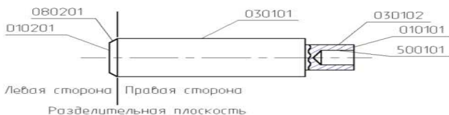
Рис. 1. Кодирование поверхностей детали «Ось» с указанием разделительной плоскости
