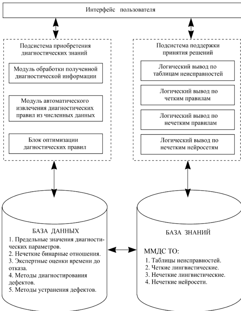
Рис. 3.9. Структура ЭС технической диагностики состояния технологического оборудования
