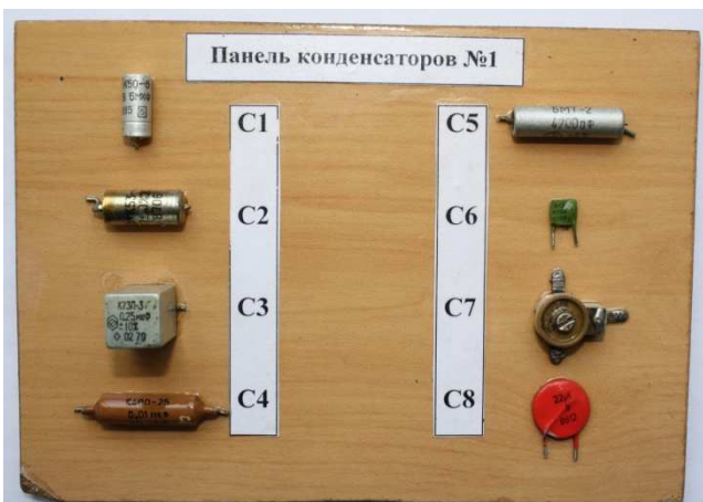
Рис. 4.1. Панель с конденсаторами
