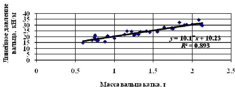
Рис. 10. Зависимость линейного давления вальца катка от его массы
