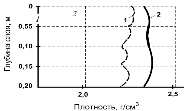
Рис. 1. Распределение плотности асфальтобетона по толщине слоя: 1 – два слоя толщиной по 7,5 см; 2 – один слой толщиной 15 см
