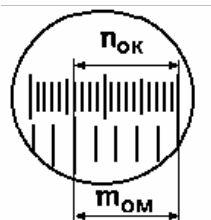
Рис. 1.3. Схема определения цены деления окуляра микроскопа
