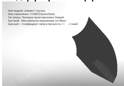
Рис. 4.7. Опасные сечения элемента стружки
