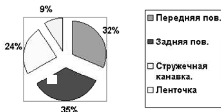
Рис. 1.24. Количество тепла (%), поступившее в инструмент на разных стадиях обработки
