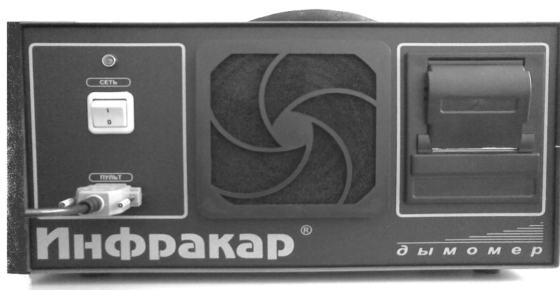
Рис. 8.2. Дымомер Инфракар Д (вид спереди)
