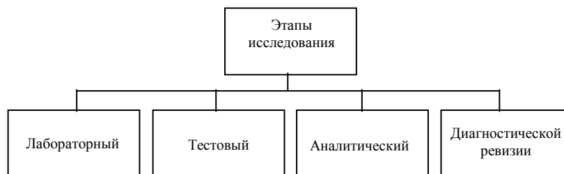
Рис. 5.1. Этапы исследования силовых трансформаторов 110 кВ
