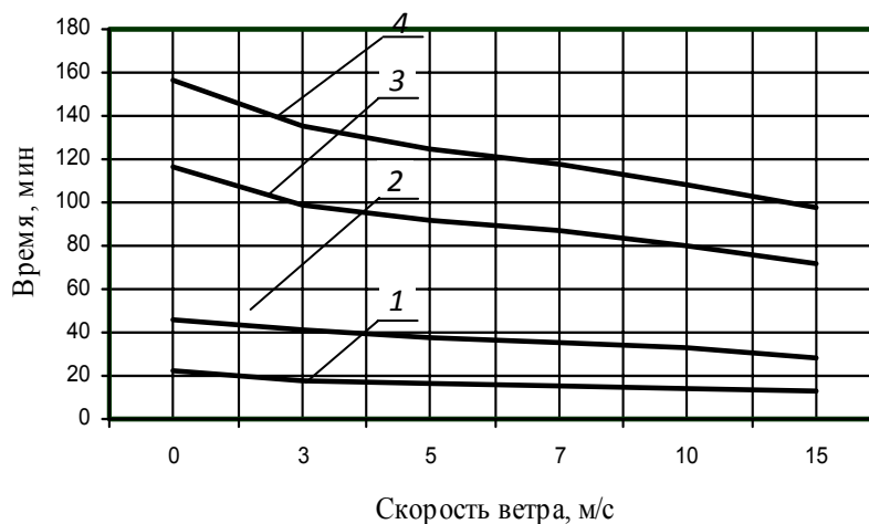
Рис. 4.6. Продолжительность процесса уплотнения в зависимости от скорости ветра (температура воздуха 20 °С, температура смеси при распределении 160 °С) при толщине слоя: 1 – 0,03 м; 2 – 0,05 м; 3 – 0,08 м; 4 – 0,10 м
