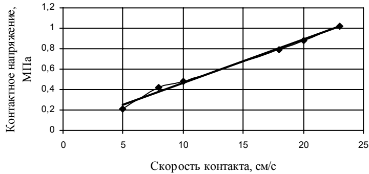
Рис. 5.36. Зависимость контактных давлений от скорости вальца в момент начала контакта с поверхностью уплотняемого материала
