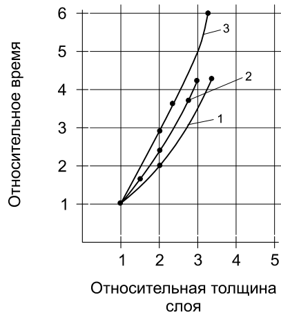
Рис. 4.9. Влияние относительной толщины уплотняемого слоя на продолжительность работ по устройству покрытия из горячей смеси: 1 – по данным Н.В. Горелышева, крупнозернистая асфальтобетонная смесь; 2 – по данным К. Нижбойера, мелкозернистая смесь; 3 – по данным эксперимента, песчаная асфальтобетонная смесь
