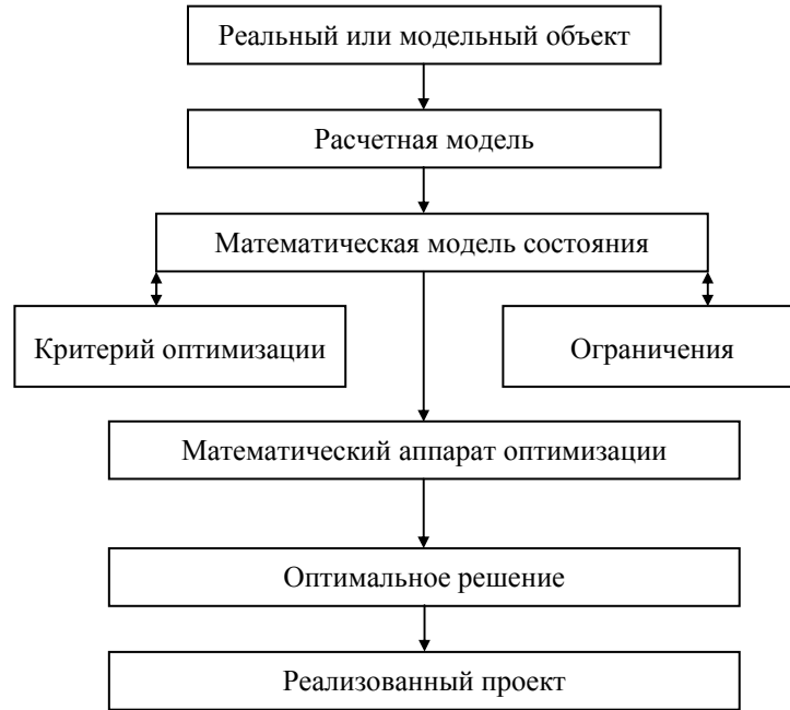
Рис. 1.13. Структурная схема получения оптимальных решений Производительность шнековой машины
