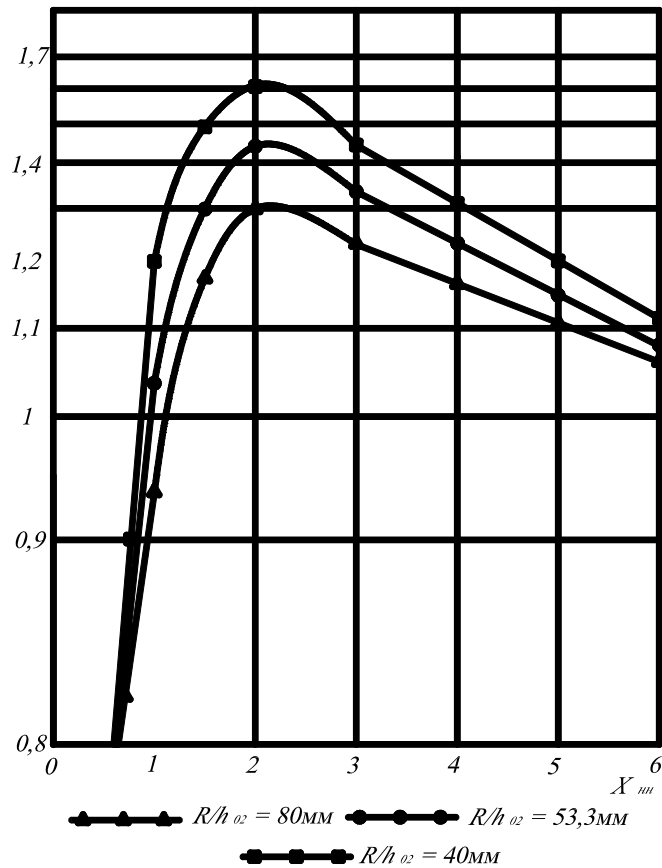
Рис. 3.52. Зависимость удельной мощности P от величины безразмерной координаты сечения входа в зоне загрузки X_{III} для трех различных значений R/h_{02} при n_r = 0,2
