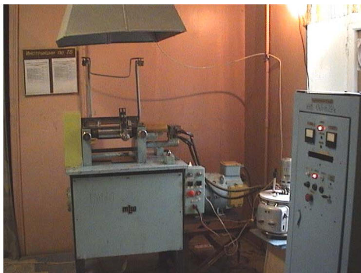
Рис. 3.47. Экспериментальная установка ЭУ2 для исследования процесса пластикации резиновых смесей
