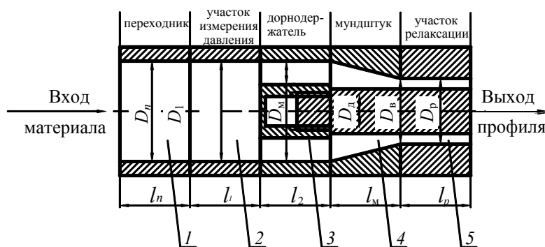
Рис. 2.4. Компоновка формующих каналов экструзионной головки:
