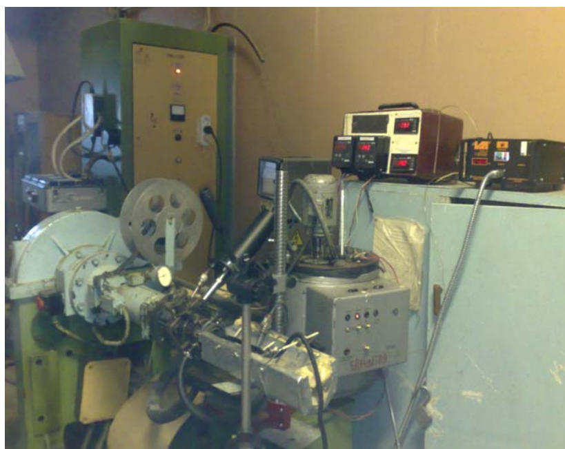
Рис. 8.1. Экспериментальная установка для исследования процессов экструзии под влиянием ультразвука
