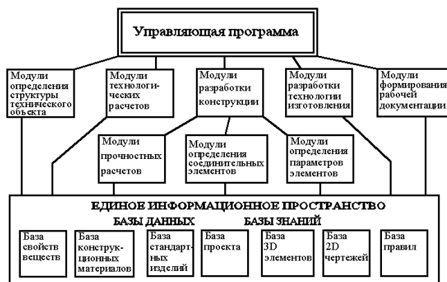
Рис. 6.2. Структура программного и информационного обеспечения автоматизированной информационной интеллектуальной системы для проектирования технологического оборудования
