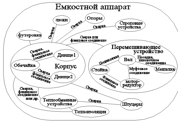
Рис. 5.2. Представление структуры ёмкостного аппарата в виде графа G = (E^b, E^s)
