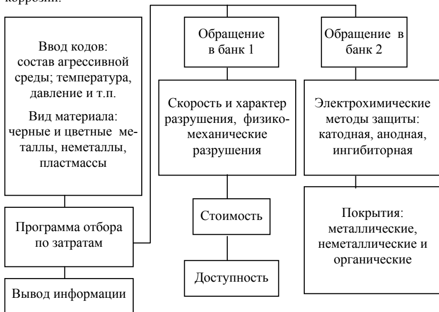
Рис. 1.3. Блок-схема программы для системы автоматизированного выбора материалов и метода защиты от коррозии
