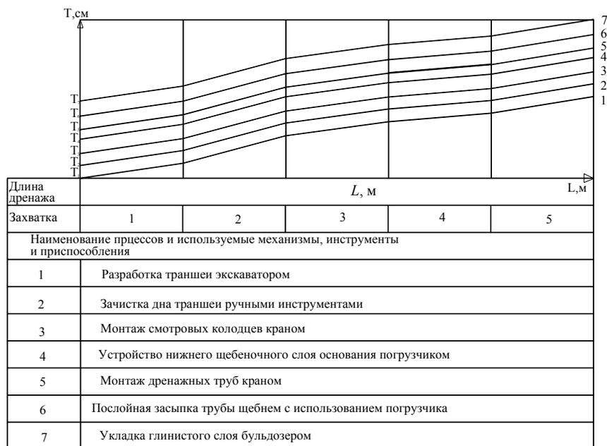
**Рис. 8. Фрагмент линейного графика производства работ:**
