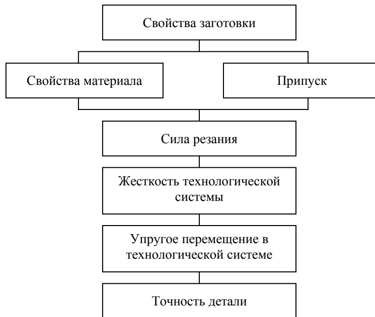
Рис. 1. Связь точности детали со свойствами заготовки
