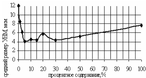
Рис. 3. Зависимость размера УНМ от процентного содержания ДМФ при УЗ диспергирования в течение 1 мин
