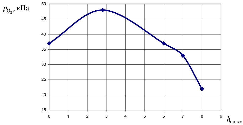
Рис. 3.12. Зависимость парциального давления кислорода в производственной смеси от высоты подъема (герметичная кабина)
