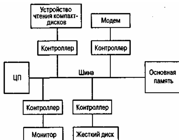
Рис. 2.8. Подключение контроллеров к шине компьютера
