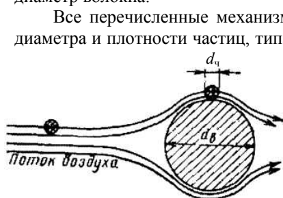
Рис. 8. Схема улавливания частиц путем касания
