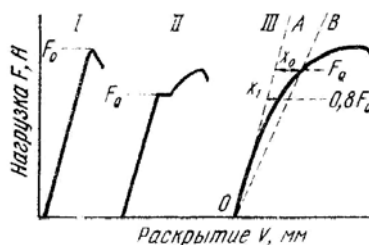
Рис. 47. Типы кривых нагрузка – раскрытие и определение вязкости разрушения
