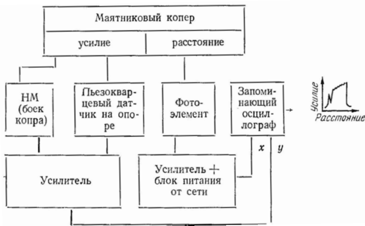
Рис. 35. Схема проведения испытаний на ударный изгиб с записью диаграмм разрушения
