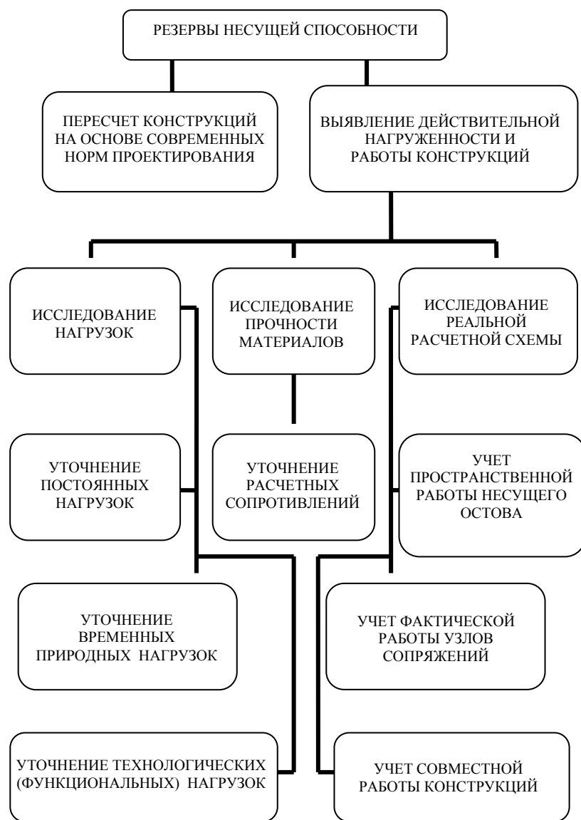
Рис. 6. Схема выявления резервов несущей способности
