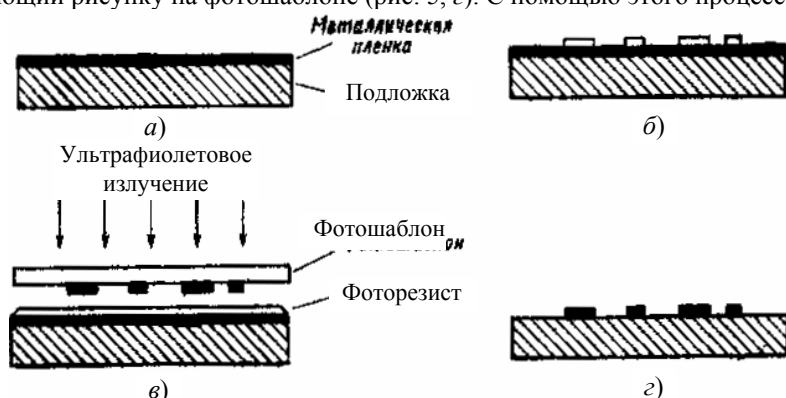
Рис. 5. Этапы изготовления фильтров на ПАВ методом фотолитографии
