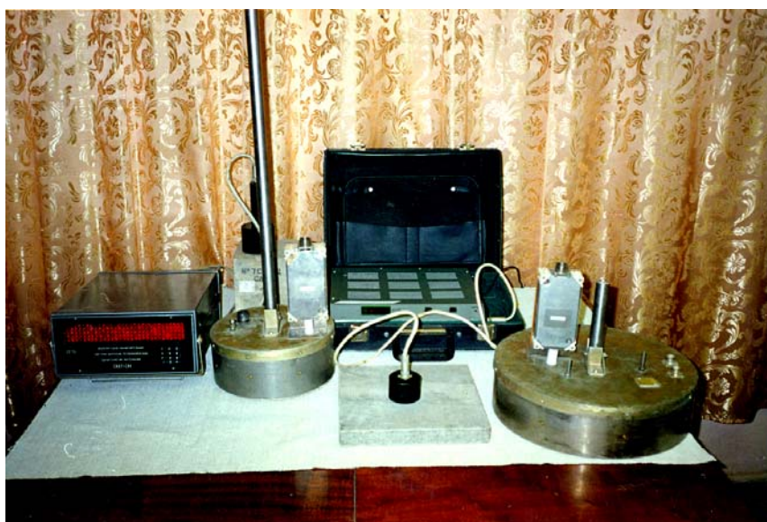
Рис. 2.15. Микропроцессорная система НК ТФС трехслойных строительных конструкций с использованием комбинации контактного и бесконтактного тепловых воздействий на исследуемый объект
