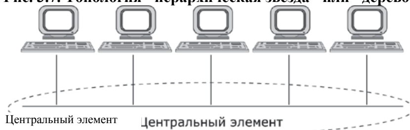
Рис. 3.7. Топология "иерархическая звезда" или "дерево"
